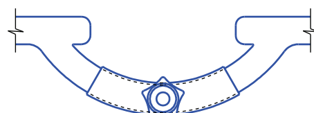
SISTEMA DE AJUSTE DA CARNEIRA ATRAVÉS DE CATRACA (BOTÃO GIRATÓRIO) ALTERNATIVA 2 (NOTA 4)
